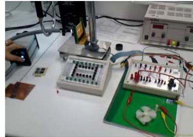
Figure 5 : Haut : schéma du banc de caractérisation. Bas : vue du boîtier de « multiplexage » (ici le boîtier est relié à un moteur de ventilateur).
